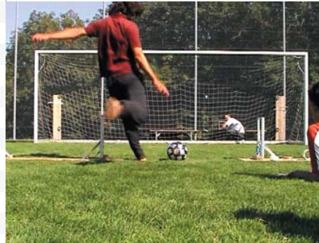
Wir markieren wo die Schüsse im Tor eintreffen. An den Bänken befindet sich die Lichtschranke, welche die Sensoren auslöst.
