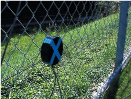
Die Radarsensoren werden am Gitter hinter dem Tor befestigt
