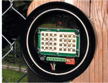
Einer der acht Radarköpfe hinter dem Tor, welche die Geschwindigkeit des Balles messen.
